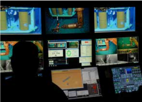
Abb. 3: Bergung von Geräten mit einer 2-Draht Operation in 4.500 m Wassertiefe. Das ferngesteuerte Unterwasserfahrzeug (ROV) befestigt an dem verlorengegangenen Gerät einen Haken, der mit dem Schiffsdraht heruntergelassen wird. Hierbei sind exakte Navigation und Positionierung, gute Absprache sowie viel Fingerspitzengefühl gefragt. Foto: Peter Linke.
