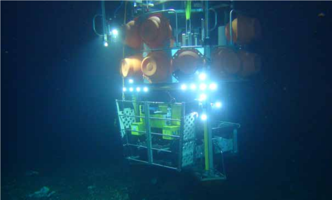
Abb. 4: Aussetzen des Crawlers VIATOR mit dem Lander MANSIO von Bord der Polarstern. Über den roten Auftriebskugeln ist die Absetzvorrichtung am Glasfaserhybridkabel, bestückt mit Kameras und Scheinwerfern, zu erkennen. Wenn der Boden in Sicht kommt, wird vom Schiff aus das Signal zum Abwurf des Landers gegeben. Nach Beendigung der Mission werden die Gewichte nach einem akustischen Auslösesignal abgeworfen, und der Lander kehrt mithilfe seiner Auftriebskugeln zurück an die Oberfläche. Fotos: oben: J. Lemburg, unten: ROV-Team GEOMAR
