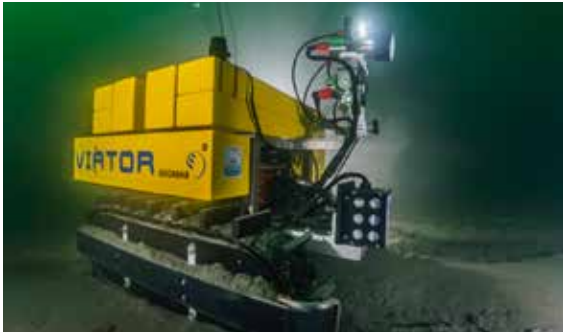
Abb. 5: Der Crawler VIATOR am Meeresboden. Hier noch mit einer „Nabelschnur“ zur Oberfläche zu sehen, wird er später mit seinen optischen und chemischen Sensoren den Meeresboden hochauflösend kartieren und selbstständig in seine „Herberge“ zurückkehren. Foto: SUBMARIS.
