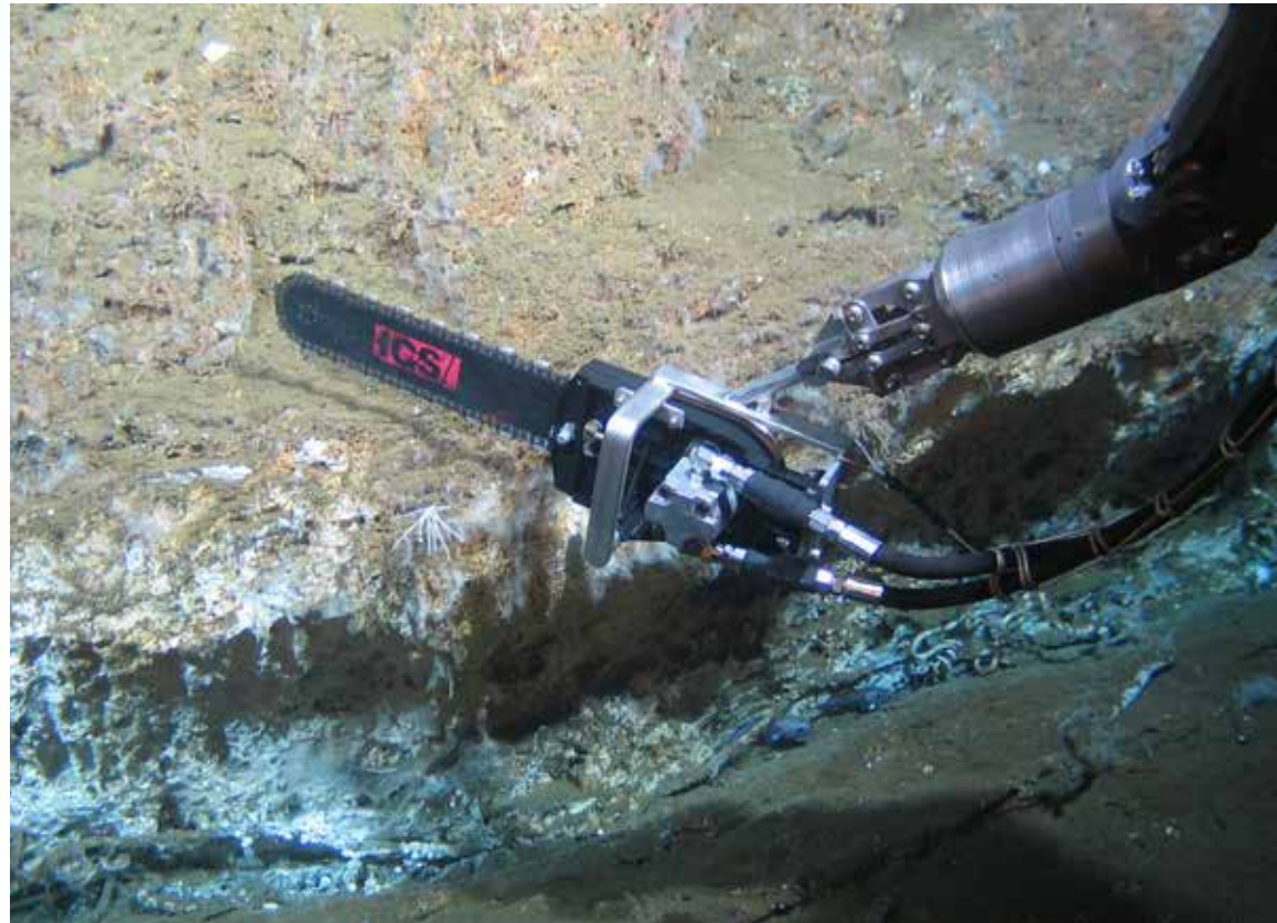
Abb. 3: Beprobung eines Karbonatblockes an einer kalten Quelle durch eine Säge während der Forschungsfahrt S0210 des Forschungsschiffes FS Sonne (2010). Foto: ROV Kiel6000.
