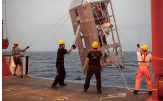
Abb. 3: Die Senckenberg-Tiefseeforscher Torben Riehl und Nils Brenke setzen in eingespielter Zusammenarbeit mit der Decksmannschaft des Forschungsschiffes Sonne den mit Kameras und Sensoren ausgerüsteten Epibenthoschlitten aus. Ungefähr acht Stunden später wird das Gerät mit gefüllten Netzen und Speicherchips voller Daten aus dem Abgrund des Nordatlantik wieder zurück an Deck geholt. Dies sind die spannendsten Momente auf Tiefsee-Expeditionen. Mit freundlicher Genehmigung von Vema-TRANSIT-Projekt, Simon Bober, Universität Hamburg.
