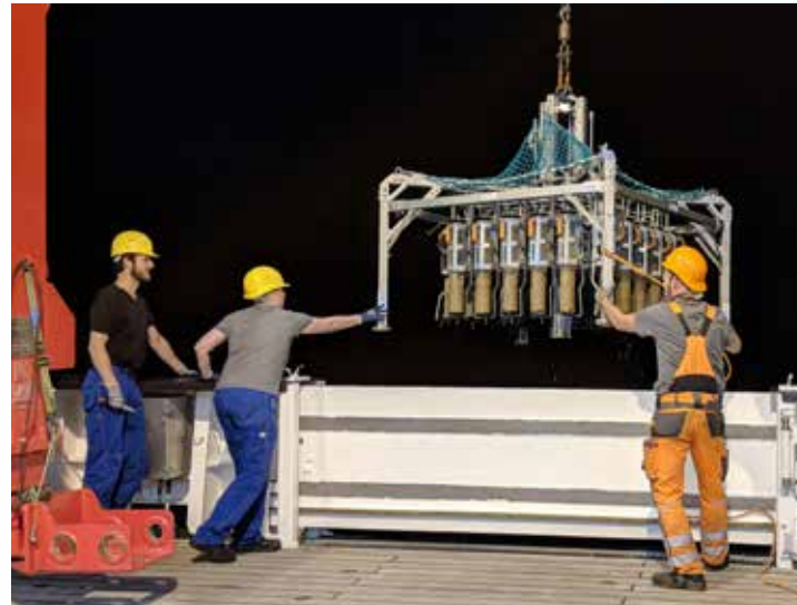
Abb. 3: Nach vier Stunden wird der Multicorer mit seinen gefüllten Plexiglasrohren aus über 5.000 m Tiefe zurück an Bord der Sonne geholt. Foto: Sophia Reichelt.
