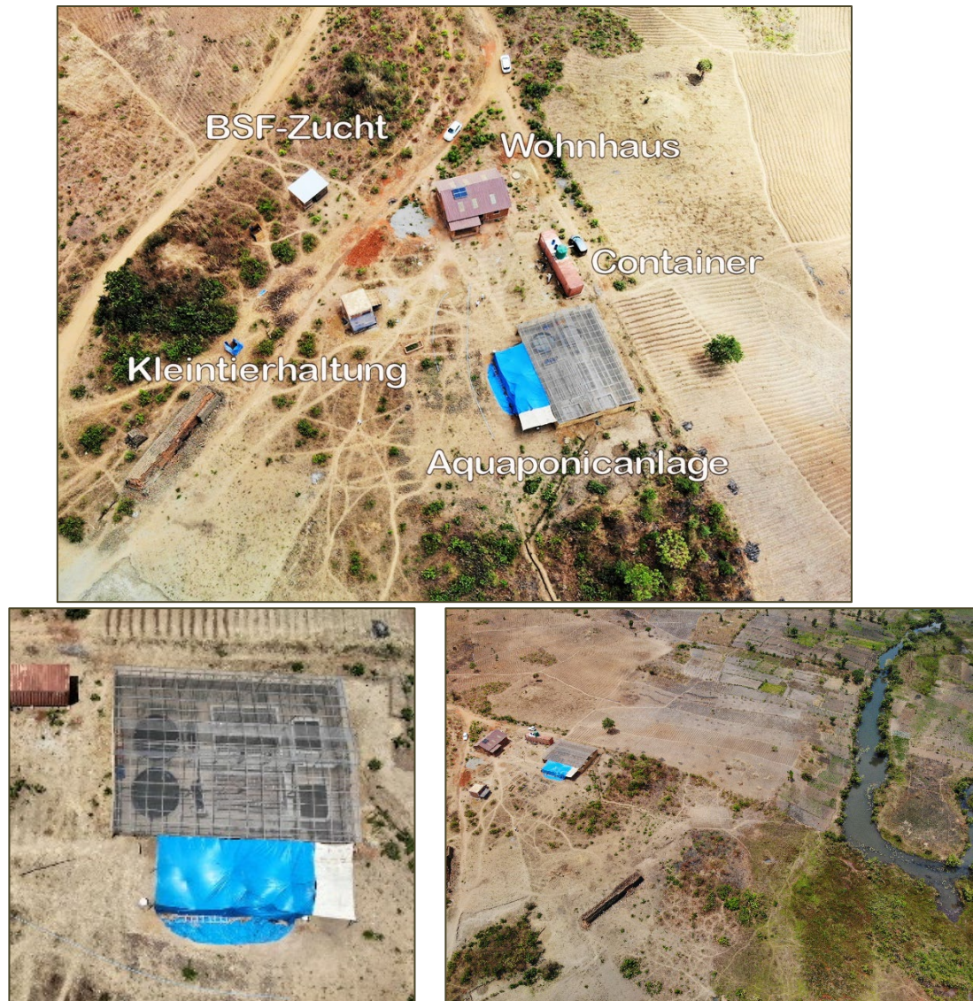
Abb. 10: Luftaufnahme von der Pilotfarm welche einen Überblick über die aktuell vorhandenen Installationen vermittelt (Aufnahmedatum 04.10.2023). Zu diesem Zeitpunkt gab es die Aquaponikanlage als zentrales Element, ein Wohnhaus, eine kleine Hütte für die BSF-Zucht und ein gemauertes Gebäude für die Kleintierhaltung (Kaninchen, Hühner, Enten). Gut zu sehen ist auch der Container mit dem Wassertank auf dem Dach. Die unteren Abbildungen zeigen noch einen vergrößerten Ausschnitt der Aquaponikanlage und einen Überblick aus welchen auch die Lage der Farm zum Fluß gut zu erkennen ist.
