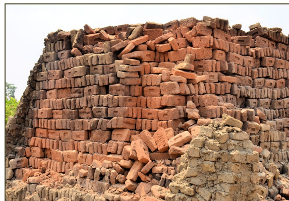
Abb. 5: Ein Wohn- und Lagerhaus wurde bereits vor der Entscheidung die Pilotfarm auf dem Landbesitz von A4L aufzubauen errichtet. Typische Herstellung der Ziegel für den Bau des Wohnhauses, Nebengebäude und der Aquaponikanlage. Links die geformten Ziegel welche zur Trocknung ausgelegt wurden. Rechts die Ziegel nach dem Brennen.
