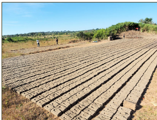
Abb. 5: Ein Wohn- und Lagerhaus wurde bereits vor der Entscheidung die Pilotfarm auf dem Landbesitz von A4L aufzubauen errichtet. Typische Herstellung der Ziegel für den Bau des Wohnhauses, Nebengebäude und der Aquaponikanlage. Links die geformten Ziegel welche zur Trocknung ausgelegt wurden. Rechts die Ziegel nach dem Brennen.
